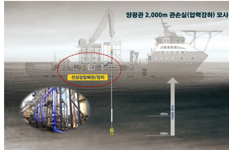
[감압배관을 통한 2,500m 양광 성능 실증 시험 개념 및 실증 장비 제작 사진]
