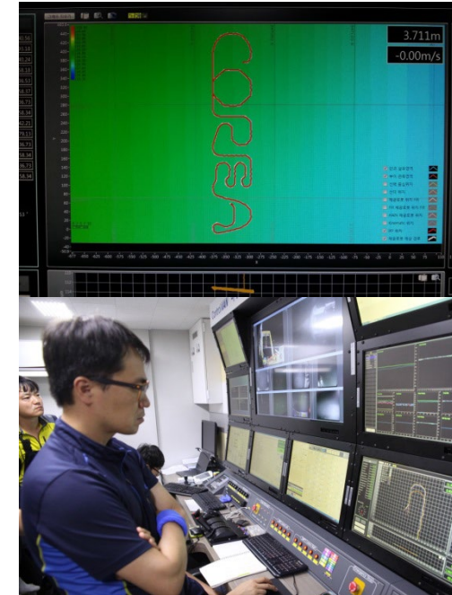
[미내로 주행 실증 시험 결과(경로추종성능, 채집성능)]
